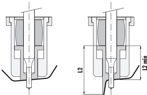
Für Stripper-Einsätze mit Teilekontur stehen Rohlinge mit den Längen 35 und 45 mm\* zur Verfügung. Diese Einsätze können individuell nach 3D-Kundendaten bearbeitet ausgeliefert werden. Die max. Schrägbelastung darf 15° nicht übersteigen! L2 min nicht unterschreiten.
