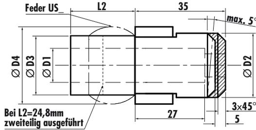
Das Kopfstück wird mit einer Länge von 35 mm ausgeliefert.
